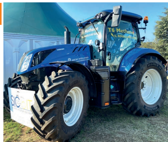
Départ usine, le T6.180 Méthane Power est proposé soit avec un réservoir de 200 l, soit complété par un réservoir à l'avant qui permet de monter à 500 l de GNV.
