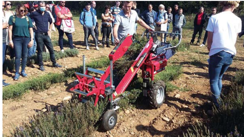
La récolteuse électrique Terrateck permet une vitesse d'avancement jusqu'à 2 km/h.
