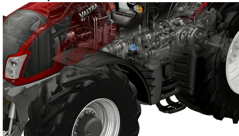
La transmission Direct de Valtra propose quatre gammes et elle est composée d'un module hydrostatique, d'un double train épicycloïdal et de deux embrayages multidisques. Crédit : Valtra
