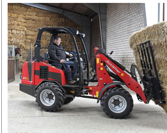
Le valet de ferme électrique 23e de Schäffer dispose de batteries au lithium-ion. © Schäffer
