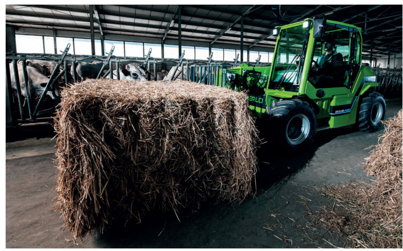
L'eWorker de Merlo dispose de moteurs électriques dans les roues avant. © Merlo
