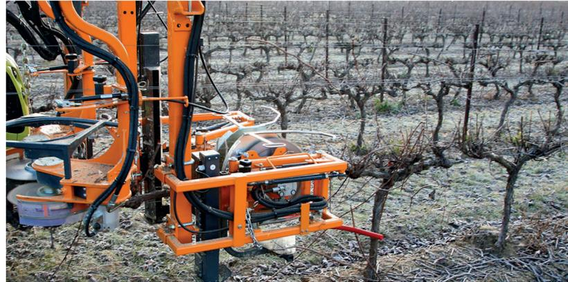
Les tailleuses se composent de deux scies à plan vertical pour tailler les côtés et de deux scies horizontales pour couper au-dessus d'une certaine hauteur du cordon. Ces dernières peuvent être pilotées par un système de vision qui **peaufine la hauteur par rapport au cordon et permet d'avancer plus vite.** ©Pellenc
