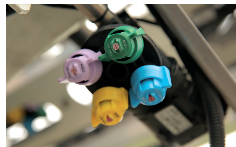
Les porte-buses à sélection automatique sont pilotés électriquement, comme sur cette photo, ou pneumatiquement. La seconde solution impose davantage de complexité avec les conduites pneumatiques. © Kuhn
