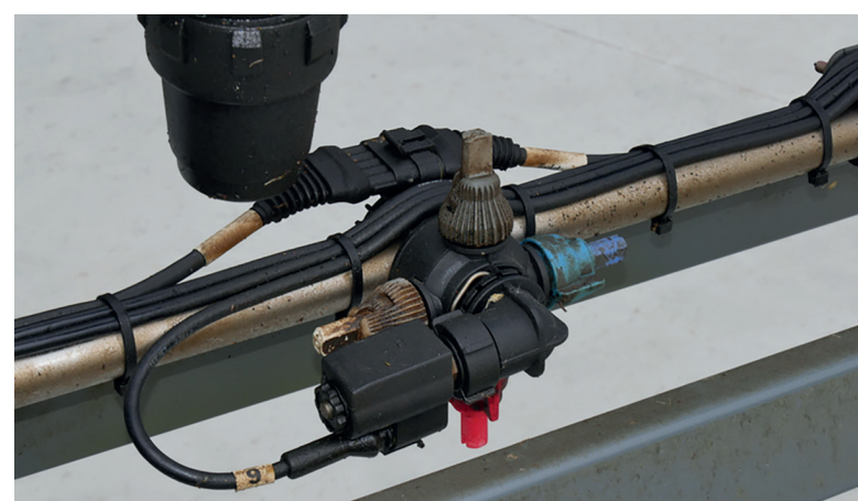
La technologie PWM utilise des porte-buses spécifiques accompagnés de boîtiers de pilotage sur la rampe. © Kuhn
