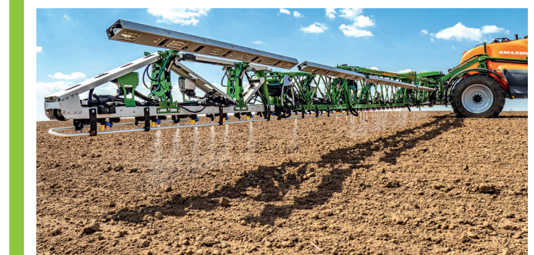
La pulvérisation ultralocalisée implique un pilotage ultrarapide des buses, imposant le recours à la technologie PWM. Crédit: Amazone
