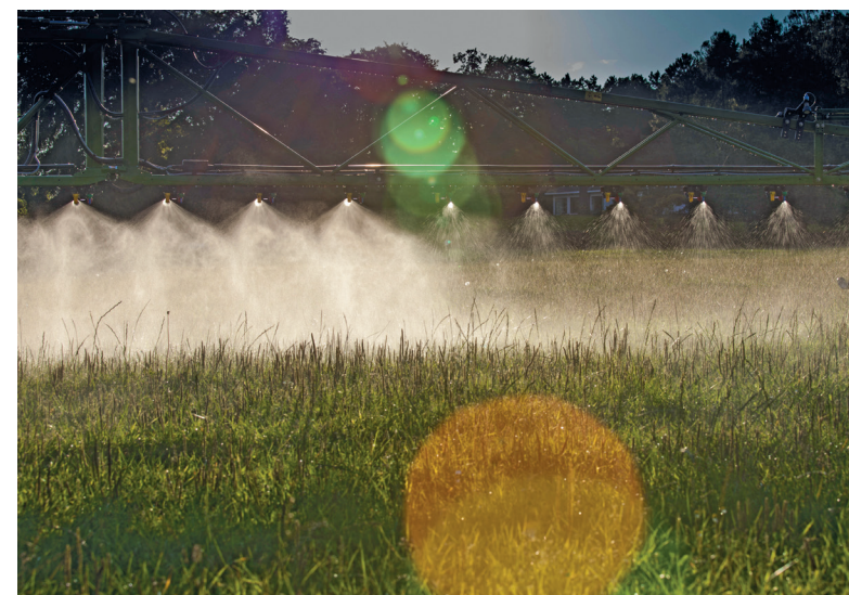
La sélection automatique de buses autorise la mise en œuvre de la modulation de dose par tronçons. ©Amazone
