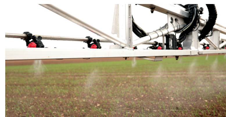
La technologie PWM utilise des porte-buses spécifiques accompagnés de boîtiers de pilotage sur la rampe. © Kuhn
