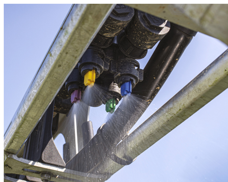
Certains systèmes multibuses autorisent l'utilisation simultanée de 4 buses. © Evrad
