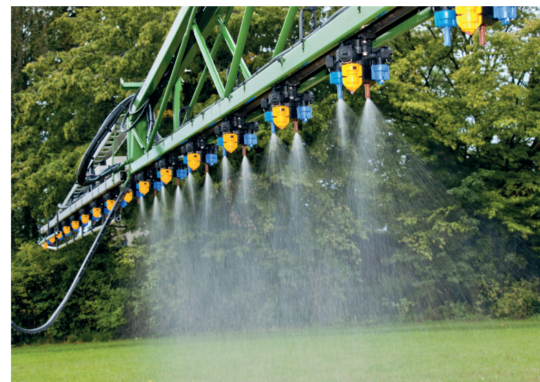
Les porte-buses à sélection automatique s'accompagne généralement d'une coupure par tronçons. ©Amazone
