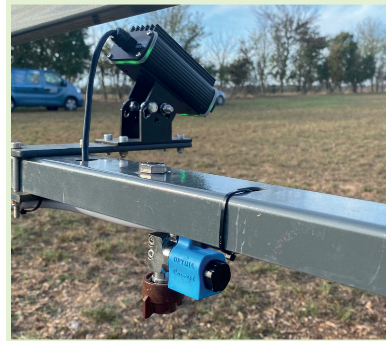
Le porte-jet SRP d'Optima Concept se démarque des autres dispositifs PWM par un volume mort très réduit autorisant une plus grande réactivité. © Optima Concept
