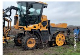
▲ Montées de manière provisoire, les chenilles permettent d'intervenir en conditions plus humides, tout en limitant les dégâts sur le sol.
