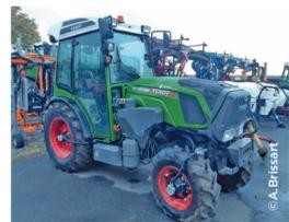
▲ Les quelques essais de télégonflage en viticulture se sont conclus par des échecs, à cause des conduites d'air extérieures qui s'accrochent dans les vignes.
