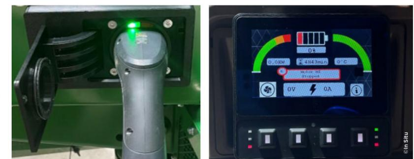
▲ L'interface d'affichage de recharge pour l'utilisateur se situe dans la cabine, tandis que la prise de recharge type T2 est à l'extérieur du tracteur.
