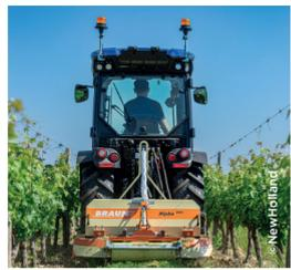
▲ Entre deux choix de gabarits de tracteurs, sélectionner le plus étroit permet de l'équiper de pneus plus larges. Un choix rarement effectué dans les faits, sauf si l'espace en cabine est identique.
