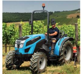
▲ Choisir un tracteur léger pour les travaux hors traction lourde limite la compaction des sols.
