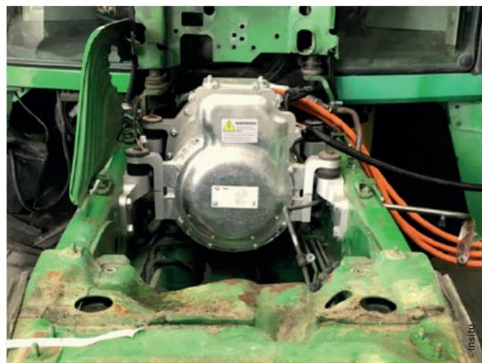
▲ Le moteur électrique est directement couplé à la transmission d'origine du tracteur.
