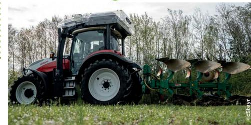
▲ Le Steyr Fctrac, basé sur le châssis du 4140 Expert CVT, est un concept équipé d'une pile à combustible à hydrogène et d'une batterie alimentant un moteur électrique.
